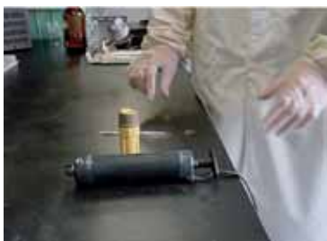
ガス採取器、検知管などの準備
