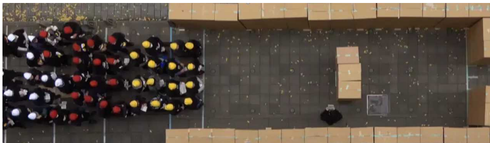
図1 実験を上空から撮影したスナップショット。帽子の色を変えることで集団内での相対位置に応じた三つのグループに分けて分析。障害物の大きさや配置でレイアウトを様々に変更し実験を行った。
